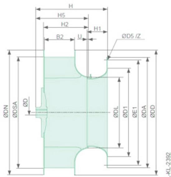
В данном разделе представлены оригинальные рабочие колеса/ крыльчатки для вентиляторных групп Ventus производства VTS
