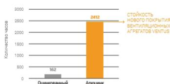
Испытания на воздействие соляного тумана по стандарту ASTM B - 117
