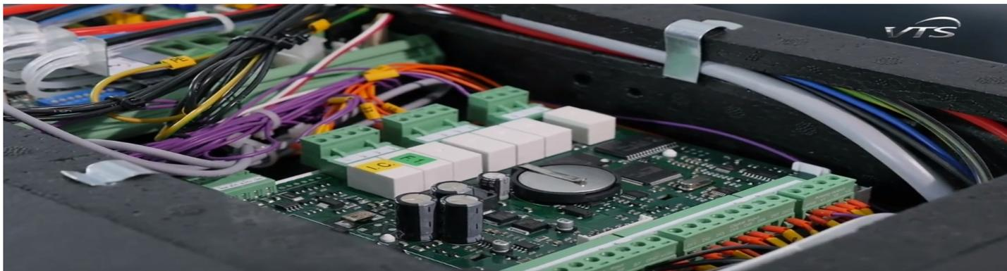
Контроллеры VTS – применяются в высокотехнологичных агрегатах, предусматривающих внешнюю локальную коммуникацию или интеграцию с системой центрального управления BMS. Аппликации автоматики VTS – схемы соединений, реализующие дистанционное управление работой агрегатов и предназначенные специально для самостоятельно работающих вытяжных установок.
